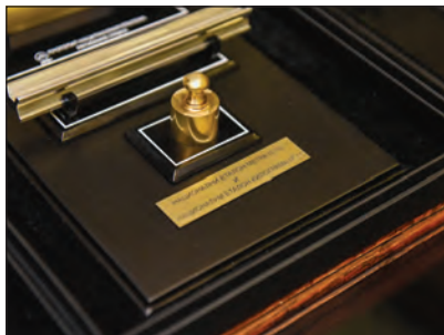
Nacionalni etalon metra N° 30 i Nacionalni etalon kilograma N° 11
