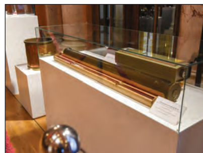
Srpski prototip metra N° 30 (godina proizvodnje 1889)
