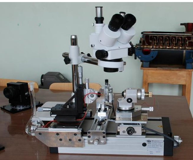
Уређај за репарацију мерних сонди са стерео микроскопом
