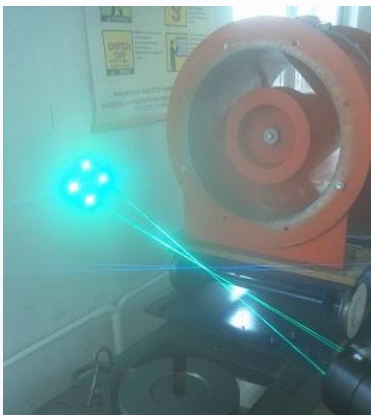
Трокомпонентна ЛДА мерења у млазу реверзибилног аксијалног вентилатора
